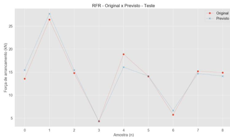
Figura 6: Resultados original versus previsto através da implementação da floresta aleatória para a parcela de teste
