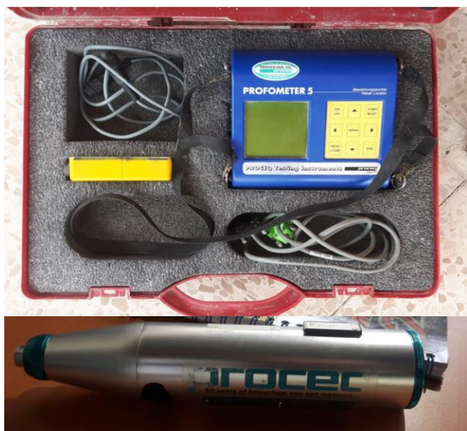
Figura 1: detector de metales, abajo, esclerómetro. Propia de los autores
