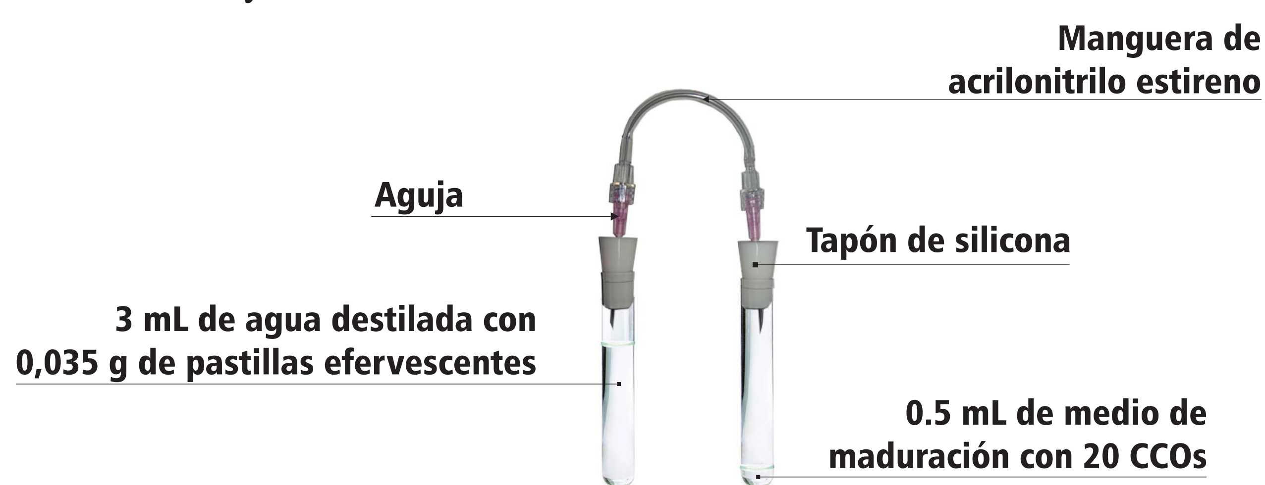
Figura 1. Sistema de gasificación química
