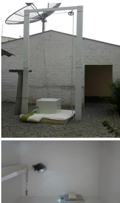
A caixa, de madeira, tem como função simular o elevador. No interior da caixa encontram-se duas lanternas, uma câmara fixa, uma mola com um objeto preso à sua extremidade, uma balança e um objeto sobre a balança.
